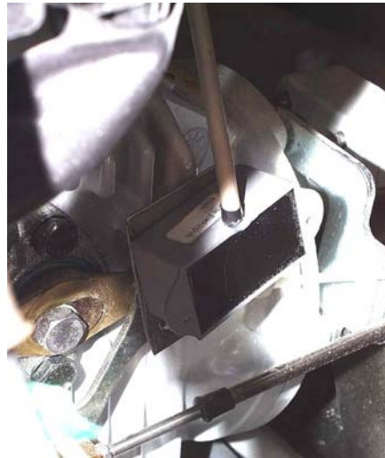
Abb. oben: Neigungssensor MLZK02 anschlussfertig Abb. Mitte: MLZK02 angebaut an Getriebe Abb. rechts: Mikroschalter im Schalthebel
